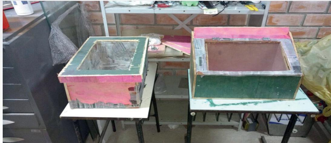
O forno tem um formato de trapézio, em que se tem uma caixa trapezoidal menor dentro de uma maior, ambas feitas com madeira. Há um espaçamento entre elas para o isolamento térmico que é feito com isopor, que está sendo repensado, pela possível contaminação dos alimentos, e também há um vidro encaixado em uma moldura de compensado para melhor recepção da radiação solar.
